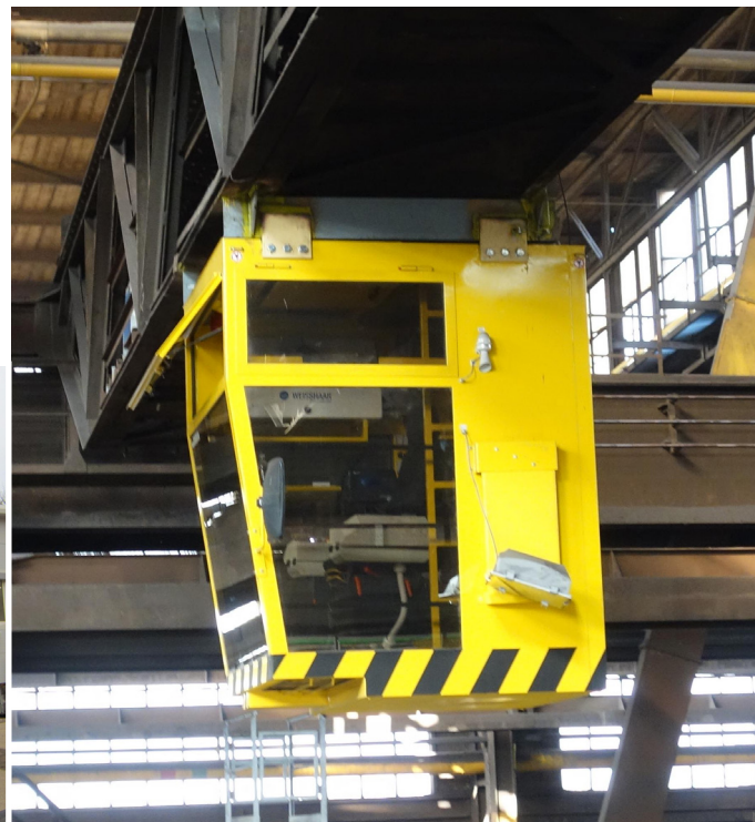
Kabiny klimatizované do vysokých teplôt - U. S. Steel Košice, s.r.o.
