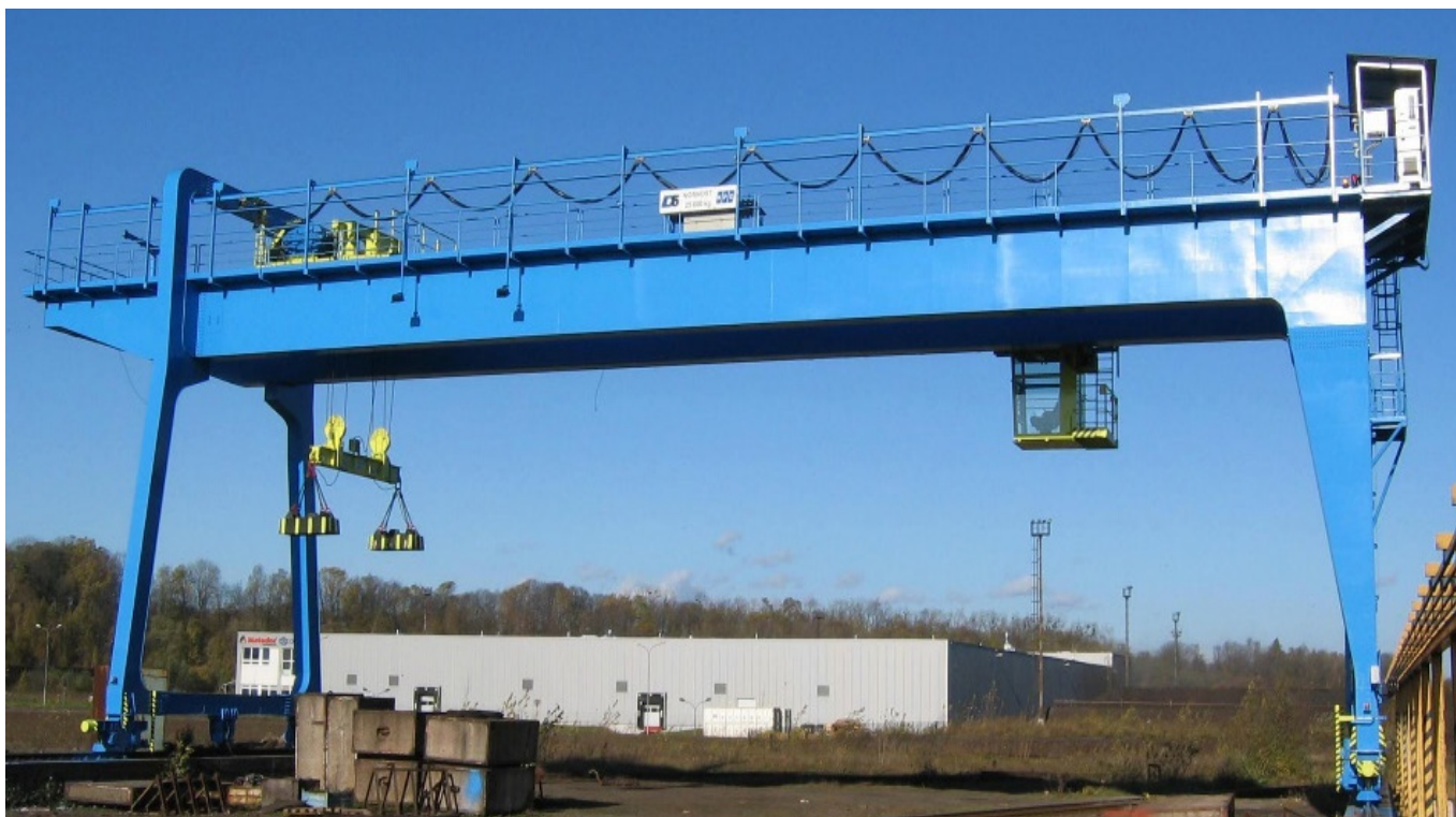
Jeřáb portálový 25t - 32m + 2,2m - Strojírny Třinec a.s.
