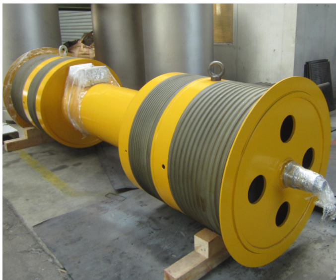
Buben lanový - nové uložení s bubnovou spojkou
