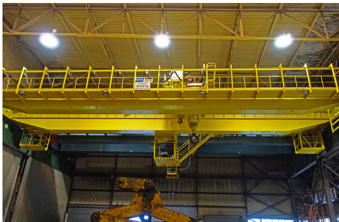
Jeřáb mostový 46t/12,5t - 28,2m - U. S. Steel Košice, s.r.o.
