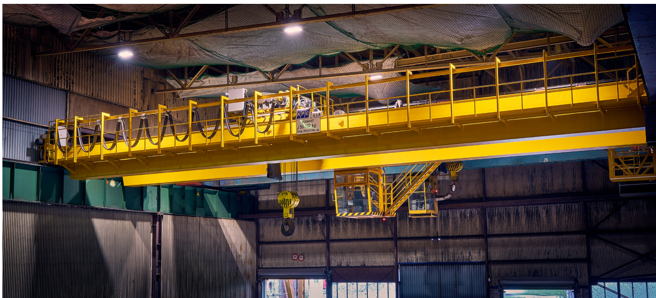
Jeřáb mostový 50t/8t - 28,2m - U. S. Steel Košice, s.r.o.
