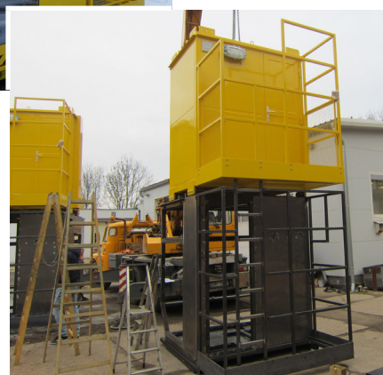
Kabiny klimatizované do vysokých teplôt - U. S. Steel Košice, s.r.o.
