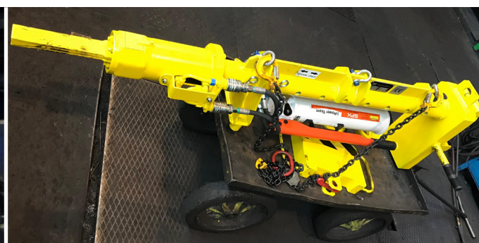
Manipulátor na manipulaci s vběhovými skříněmi - ArcelorMittal Ostrava a.s.
